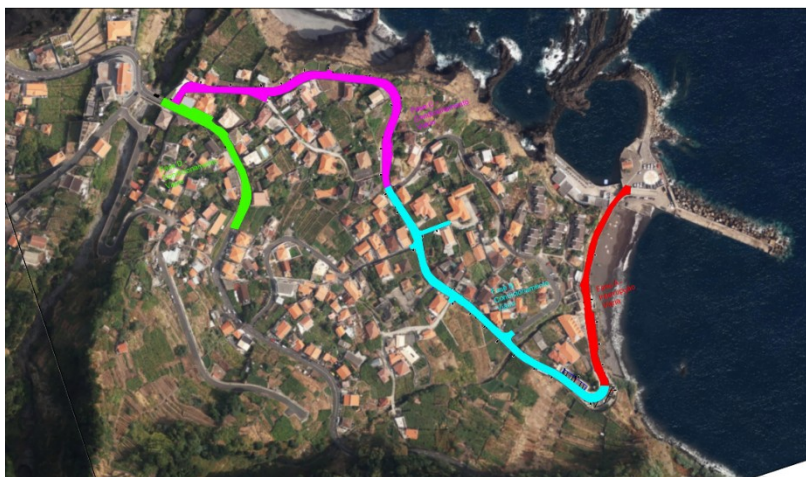
FASE A - 1200 m2 - Interrupção Viária FASE B - 2170 m2 - Condicionamento Viário FASE C - 2220 m2 - Condicionamento Viário FASE D - 1235 m2 - Condicionamento Viário
