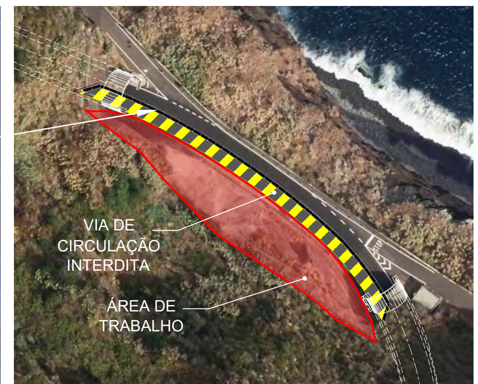
PORMENOR DA ZONA INTERDITA Esc. 1:1000
